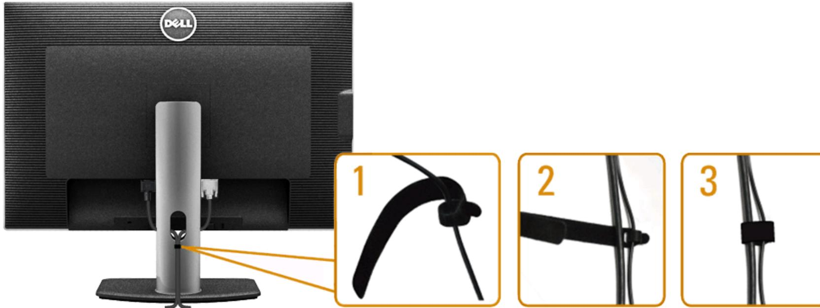
Setelah memasang semua kabel yang diperlukan ke monitor dan komputer, (Lihat [Menyambungkan Monitor](#) untuk pemasangan kabel,) gunakan slot manajemen kabel untuk mengatur semua kabel seperti ditunjukkan di bawah ini.
